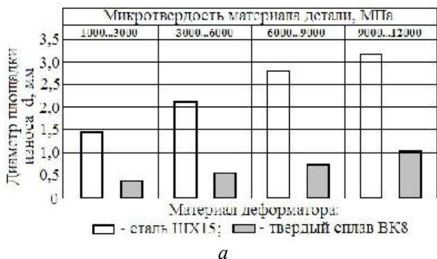
Рис. 1. Износ деформаторов при обработке различных групп материалов
