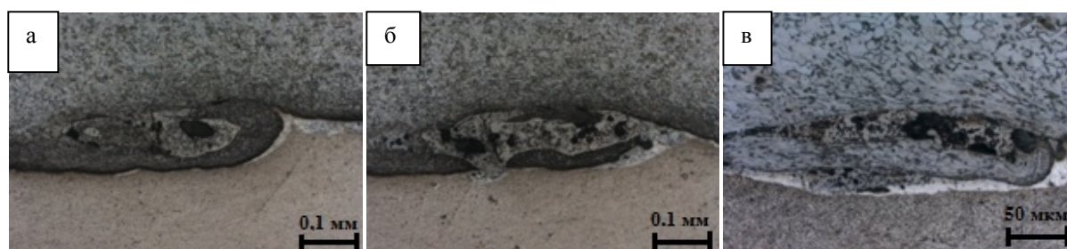
Рис. 4. Особенности строения «вихревого мешка» на стыке соединения «сталь Ст3 + алюминий А5М»
