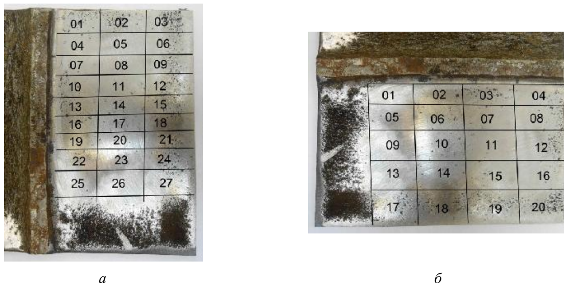
Рис. 2. Схема замеров акустических характеристик с образца металла реактора синтеза карбомида: а – поперек образца; б – вдоль образца
