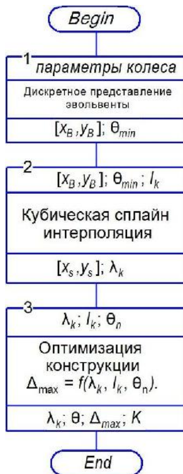
Рис. 2. Блок-схема алгоритма оптимизации проектных параметров гиперболоидной фрезы.
