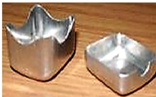
Рис. 5. Внешний вид детали: после операции вытяжки, без обрезки припуска – слева, и с магнитно-импульсной обрезкой - справа
